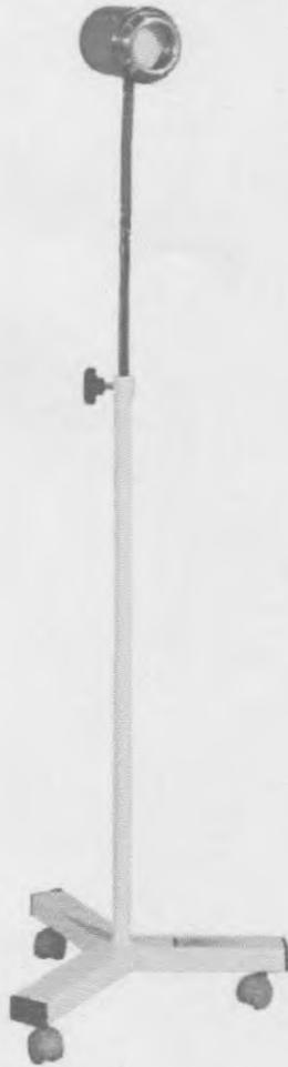
Estrutura feita em tubo de 7/8" x 1,20mm, base com metalon 50x30mm, haste móvel flexível e lâmpada led para iluminação.
