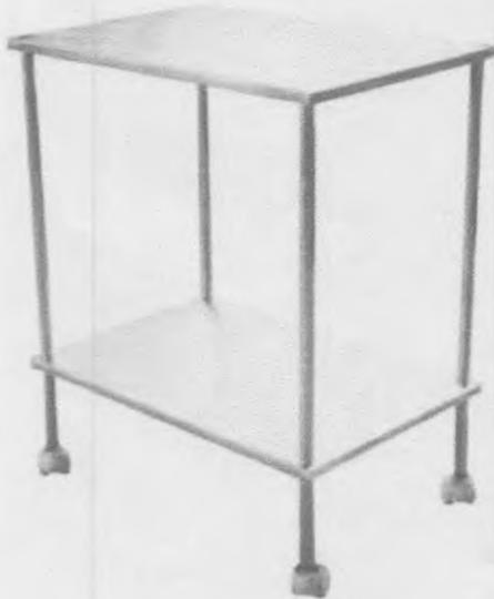
Estrutura: em tubo de aço carbono redondo diam. 7/8". Tampo e prateleira: em chapa de aço carbono Estrutura: em tubo de aço carbono redondo diam. 7/8". Tampo e prateleira: em chapa de aço carbono Acabamento: em pintura eletrostática à pó com eficiência anticorrosiva por meio de fosfatização, conferindo excelente resistência química contra corrosão.
