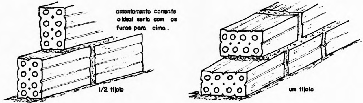
Figura 1 - Execução de alvenaria utilizando tijolos furados.
