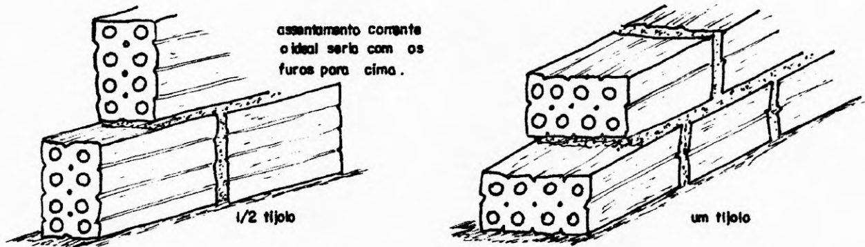
Figura 1 - Execução de alvenaria utilizando tijolos furados.
