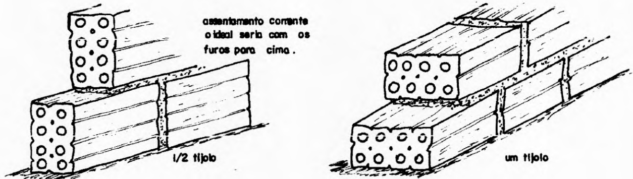
Figura 1 - Execução de alvenaria utilizando tijolos furados.
