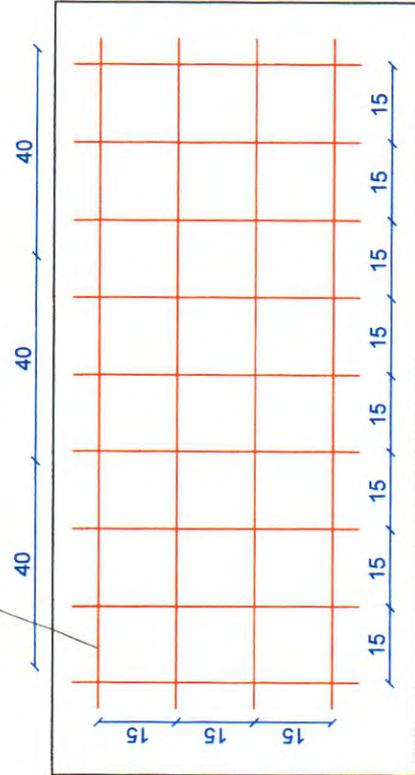
**06** DETALHAMENTO DA ARMADURA DA LAJE
