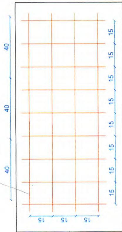
06 DETALHAMENTO DA ARMADURA DA LAJE
